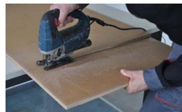
После резки панель поворачивают срезом вверх и место «среза» проклеивают клейкой лентой Wolf Tape.
